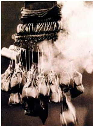
Ŝarĝo de fu-go . Maldekstre-dekstre: Cilindraj fajrigo-bomboj, sablosakoj, bombo (sube, en ombro), kaj eksplodeta ŝtopilo por aŭtomate faligi sablosakon. Super ĉio estas la altitudo-regulilo, baterio, kaj aliaj bezonaĵoj.
